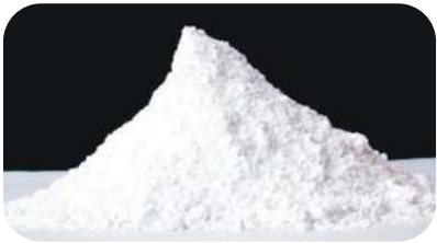
Carbonato di calcio precipitato (PCC)
